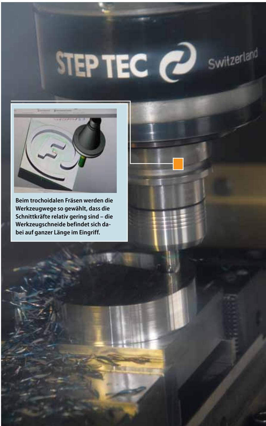
Beim trochoidalen Fräsen werden die Werkzeugwege so gewählt, dass die Schnittkräfte relativ gering sind – die Werkzeugschneide befindet sich dabei auf ganzer Länge im Eingriff.
