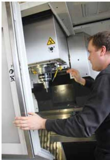
Das Bearbeitungszentrum Mikron HPM 600 HD ermöglicht, Werkzeuge und Bearbeitungen in ihre Grenzbereiche zu fahren.
