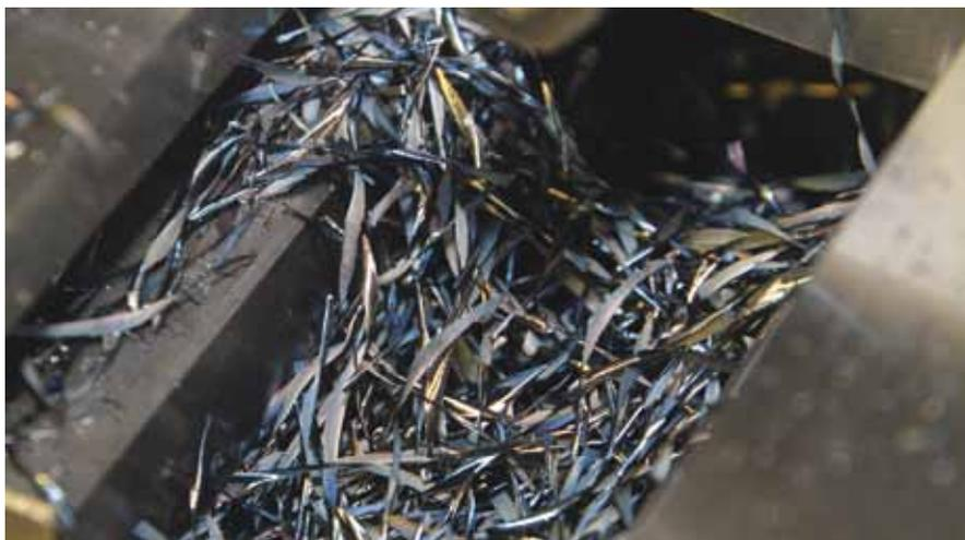
Die Späne zeigen, dass die Schneiden beim Trochoidalfräsen das Material optimal zerspanen haben:
